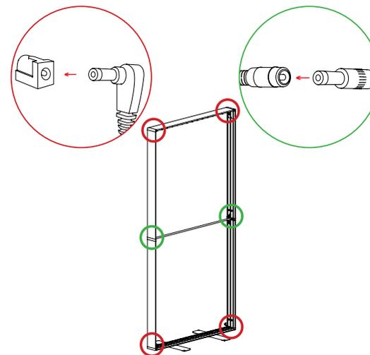
Attention, bien débrancher les câbles avant de démonter la structure
