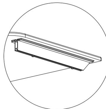
**1/** Poser la tablette sur le comptoir monté et ajuster pour que les perçages soient en face de l'insert fileté **FX866** (déjà intégré dans la tablette)
