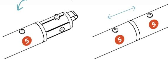
Assemblage des sections 50 mm
