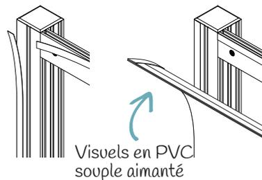
L'habillage par panneaux rigides (5mm) vous permet d'encastrer directement le panneau dans la rainure du mât. Dans le cas où vous souhaitez habiller entièrement la structure, des velcros mâle et femelle seront utilisés au dos et sur la structure.
