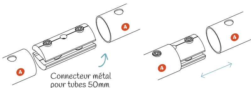
Verrouillage des sections par clé Allen
